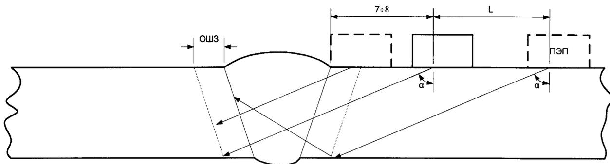
Рис. 2 Схема сканирования СС (показано прозвучивание с одной стороны); ОШЗ равна толщине СС,  $L+(7\div 8)$  мм – зона сканирования;  $L=Htg\alpha$
