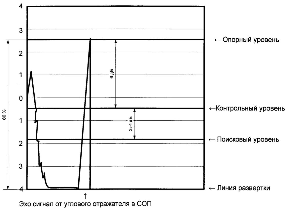
Рис. 1 Осциллограмма экрана дефектоскопа и уровни чувствительности контроля
