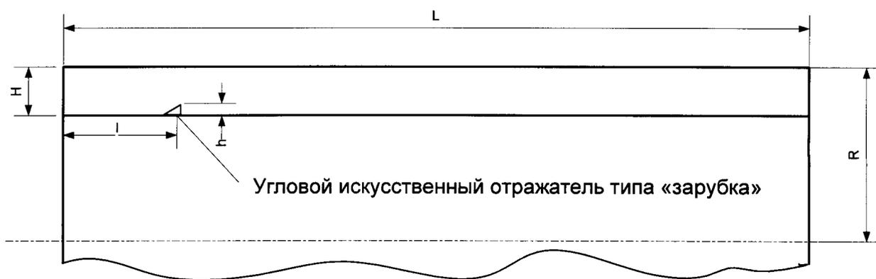
$l$  – расстояние от торца образца до отражающей грани зарубки;
